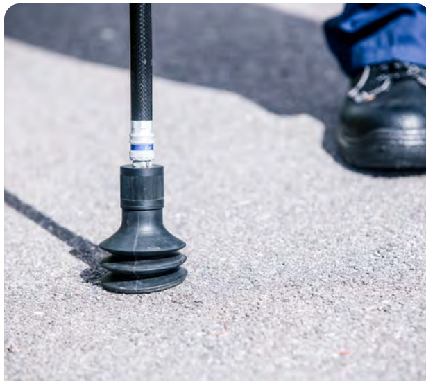
真空罩与地面之间形成密闭空间，迫使地下的气体透过路面上升。
