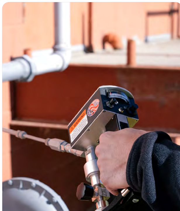
用于查找燃气泄漏的火焰离子检测器。
