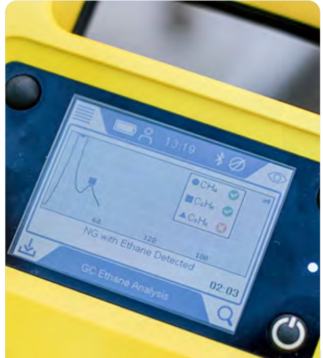
内置气相色谱仪,进行现场气体分析。
