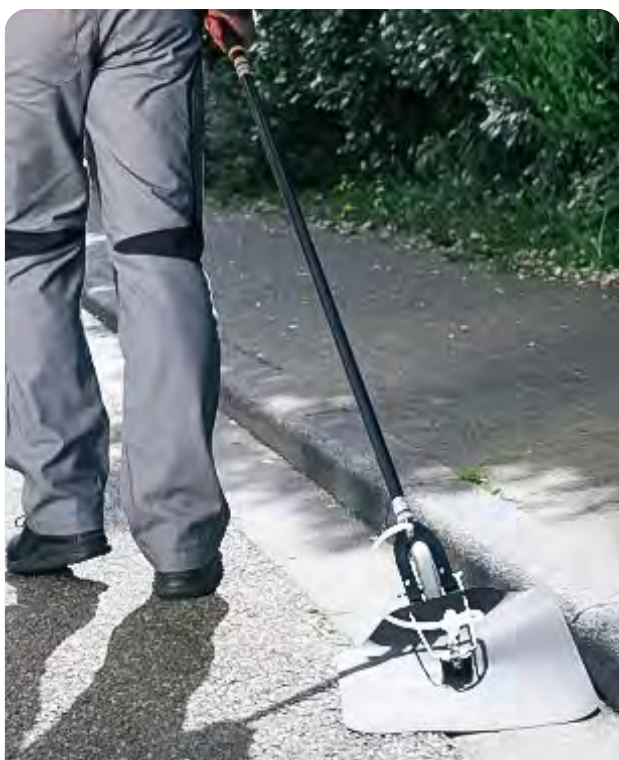
地毯式探测器的末端有一个带轮子的支架，支架上面有一块橡胶垫。
