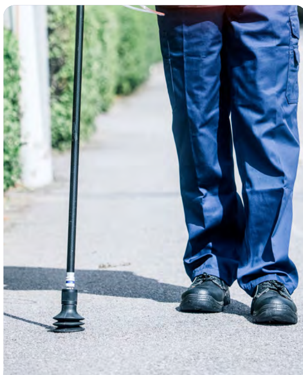
使用钟形探头进行巡检时，可以如同握住滑雪杆一样握住探杆，像北欧越野行走的方式向前移动。
