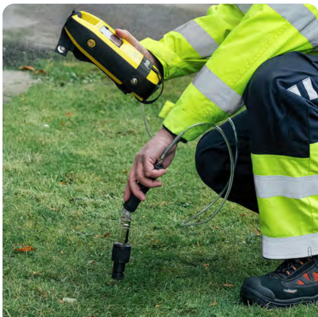
可借助排孔进行检测，以确定浓度最高区域的位置。
