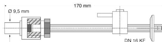
Abb. 3: Prüfleck mit Stiftgehäuse und VCO-Anschluss
