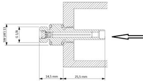
Abb. 7: <-- = Druckseite, Maximaler Betriebsdruck 40 bar
