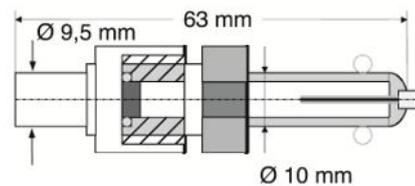
Abb. 4: Prüfleck mit zylindrischem Gehäuse und VCO-Anschluss
