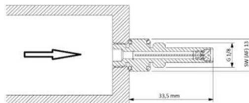
Abb. 6: --> = Druckseite, Maximaler Betriebsdruck 40 bar
