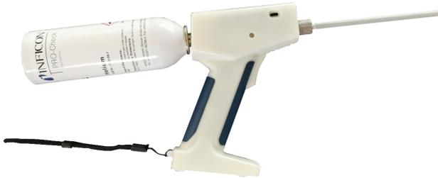
Abb. 1: SMART-Spray mit Heliumbehälter
