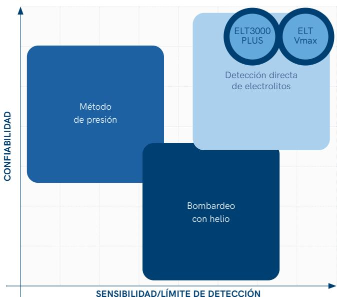
Una vez que las baterías se han formado y envejecido, las pruebas de fugas permiten rechazar las celdas defectuosas antes de seguir procesándolas. Tras soldar las celdas de la batería para formar módulos o grupos electrógenos, se vuelve a realizar la prueba de fugas.
