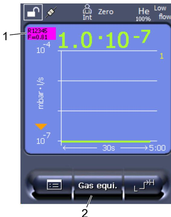
Рис. 7: Измерительный экран с индикацией эквивалентной интенсивности утечки и настроенной кнопкой избранного
