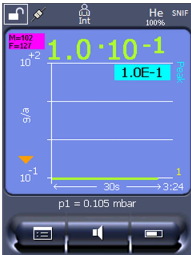
Рис. 8: Слева сверху: Отображение молярной массы (102) и коэффициента эквивалентности (127)
