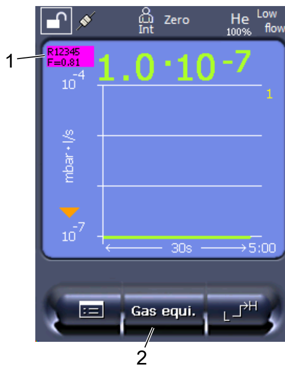
Fig. 7: Schermata di misurazione con visualizzazione del tasso di perdita di equivalenza e impostazione del pulsante Preferiti
