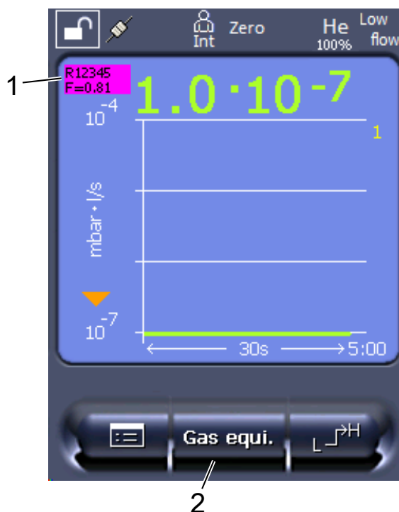
Fig. 7: Tela de medição com taxa de fuga de equivalência exibida e tecla de favoritos configurada
