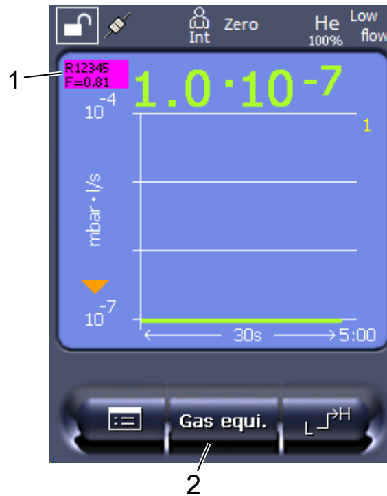
Рис. 23: Измерительный экран с индикацией эквивалентной интенсивности утечки и настроенной кнопкой избранного
