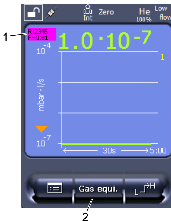
Rys. 14: Ekran pomiarowy z wyświetlaniem równoważnego wycieku i skonfigurowanym przyciskiem "Ulubione"
