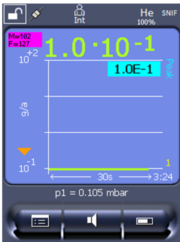
Obr. 24: Vlevo nahoře: Zobrazení molární hmotnosti (102) a faktoru ekvivalence (127)
