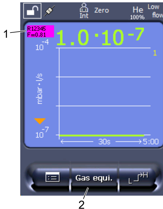
Obr. 23: Obrazovka měření se zobrazenou ekvivalentní mírou netěsnosti a nastaveným tlačítkem Favorité
