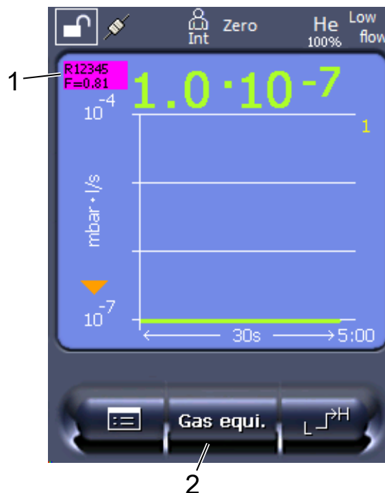
Fig. 14: Tela de medição com taxa de fuga de equivalência exibida e tecla de favoritos configurada
