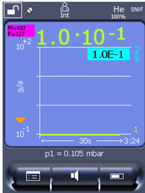
Fig. 24: Parte superior esquerda: Exibição da massa molar (102) e do fator de equivalência (127)
