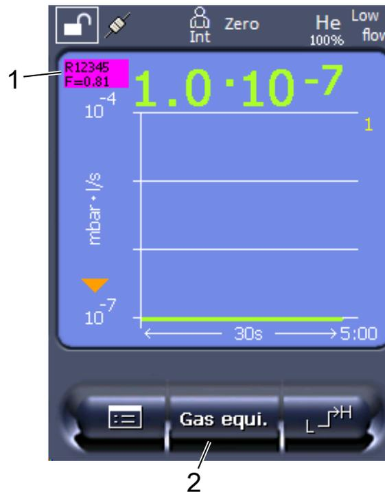
Fig. 23: Tela de medição com taxa de fuga de equivalência exibida e tecla de favoritos configurada
