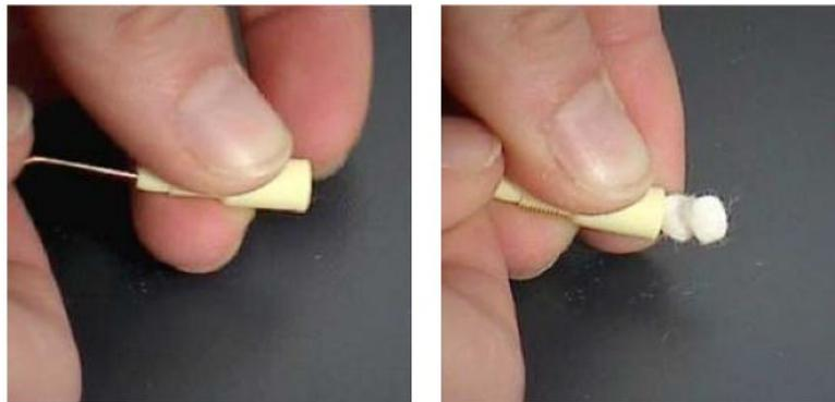
圖 18:將濾芯從毛細管過濾器壓出
