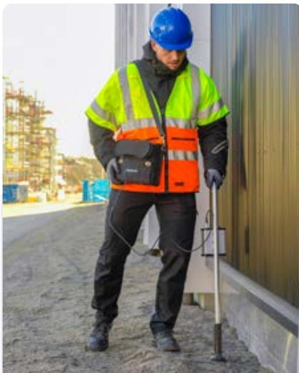
Der **Wasserstoff-Lecksucher XRS9012** verfügt über eine breite Palette an Zubehör für die Lecksuche an stromführenden und entleerten Rohren, in Innenräumen und im Freien sowie in allen Arten von Materialien. Das Gerät kann auch als Ergänzung zu bereits vorhandenen Geräten bei der Suche nach einem bekannten Leck verwendet werden.
