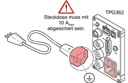
Wird das Gerät in einen Schaltschrank eingebaut, empfehlen wir, die Netzspannung über einen geschalteten Netzverteiler zuzuführen.
