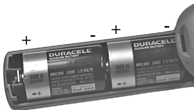
Figure 1. Installation adéquate des piles alcalines
