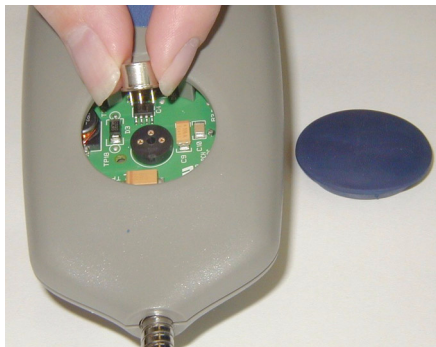
Figure 2. Installation du capteur
